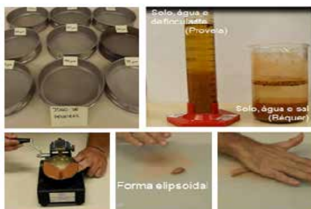
Figura 2 - Ensaios de granulometria: peneiramento e sedimentação; Ensaios para determinação dos limites de liquidez e limites de plasticidade
