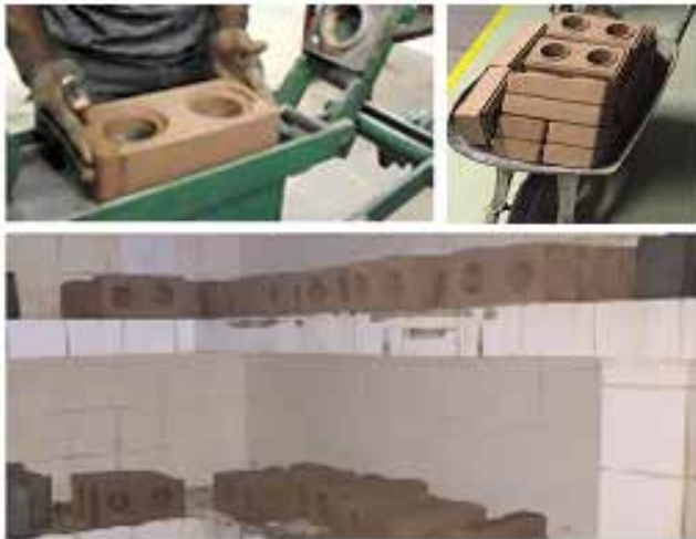
Figura 4 - Fabricação e retirada do tijolo solo-cimento na prensa manual; transporte e armazenamento em câmara úmida durante o processo de cura
