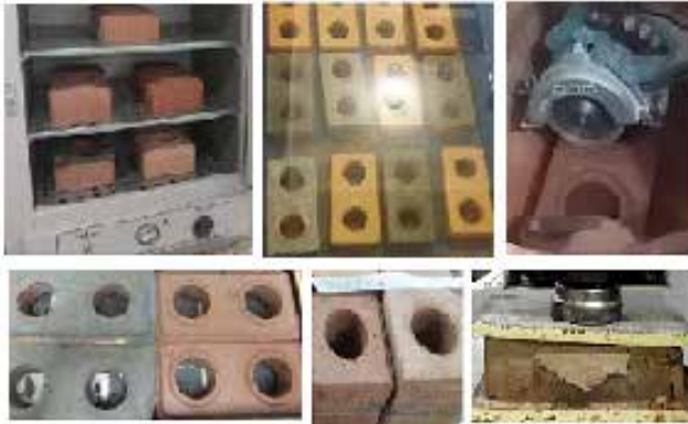
Figura 5 - Tijolos solo-cimento: preparação para ensaio de absorção e testes de resistência a compressão.
